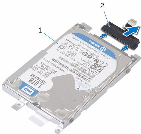
1 διάταξη σκληρού δίσκου 2 ενδιάμεση διάταξη σκληρού δίσκου
